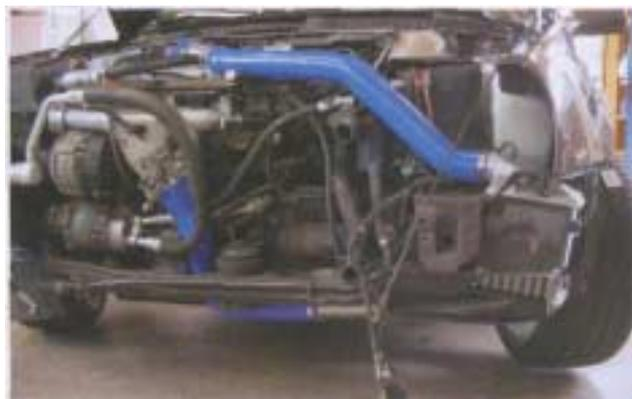
12. Frontal gesehen: Vollständig montierte Druckluft-Führungsschläuche zum Ladeluftkühler hin (oberes Rohr-/Schlauchsystem) und vom Ladeluftkühler weg bis hin zur Drosselklappe (unteres Rohr-/Schlauchsystem)
