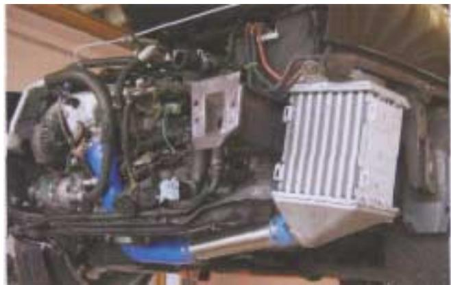
9. Andere Ansicht: Die Schlauch- und Rohrführung ist vom Ladeluftkühler bis zur Drosselklappe unter dem Ansaugrohr verlegt und angeschlossen worden
