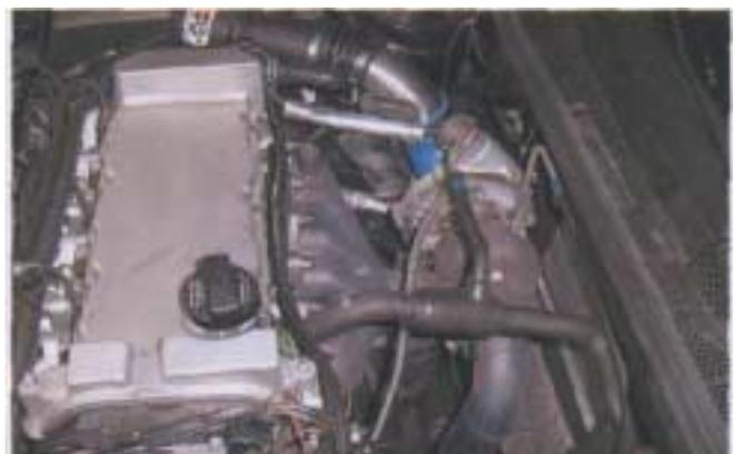
2. Auf den gereinigten Motorblock kommt die Stahlplatte mit je einer Zylinderkopfdichtung darunter und darüber. Dann wird der Zylinderkopf festgeschraubt. Anschließend den Ventildeckel montieren. Jetzt wird der neue Abgaskrümmen angeschraubt
