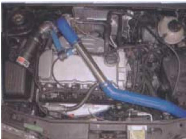
14. Das komplett angebaute TurbonachrüstSystem einschließlich montierter Front
