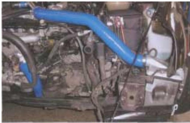
11. Jetzt die obere Luftführung vom Ladeluftkühler bis zum Druckrohr per Siliconformschlauch montieren. Die Kühlrippen des Ladeluftkühlers sind jetzt hinter den bereits angeschraubten Luftleitelementen für die korrekte Zuführung des Fahrtwindes versteckt
