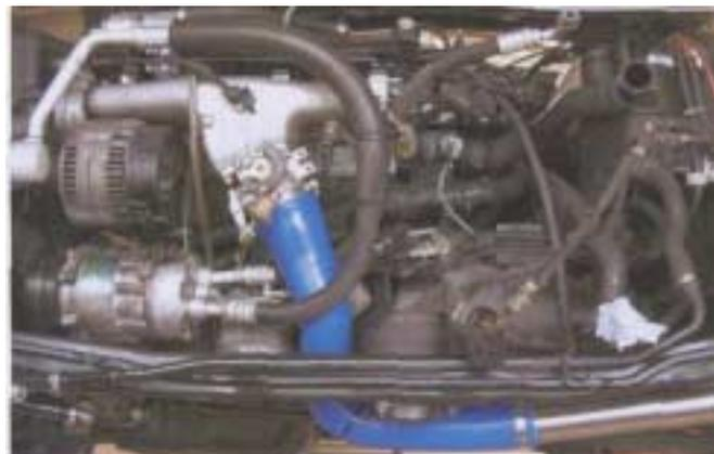
10. Gaszug und Röhrcchen für den Ölmesstab sind am Saugrohr befestigt. Die Ölzulaufleitung für den Turbo wird als Abzweigung am Öldruckschalter montiert. Oben ist der Ölzulauf an seinen Eingang am Turbolader angeschlossen
