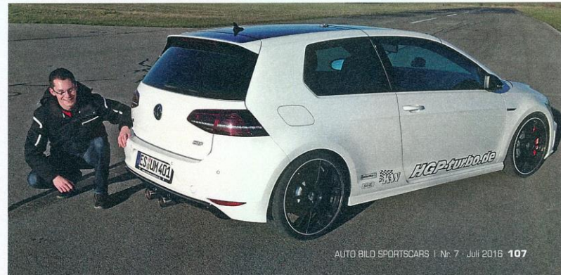
Klassische HGP-Garnierung mit großer Achtkolben-Bremse, OZ-Rädern und KW-Federn. Die mittigen Doppelendrohre kosten samt neuer Heckschürze 2000 Euro extra
